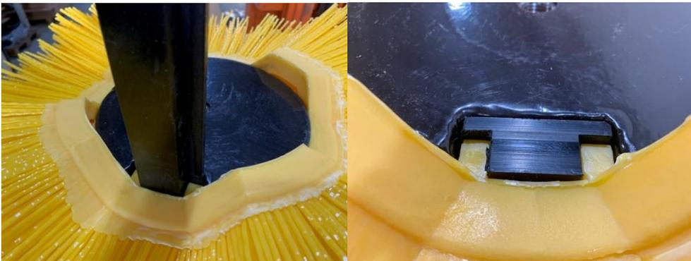
6. Montieren Sie den Spannerdeckel mit der DriLoc-Schraube und der Bundscheibe. Ziehen Sie alle Schrauben fest.
